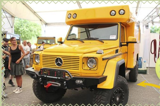
**LETECH G-KLASSE** Der Fahrwerksspezialist hat der Mercedes G-Klasse ein paar Zusatzstoßdämpfer und eine Monocoque-Kabine verpasst, ...
