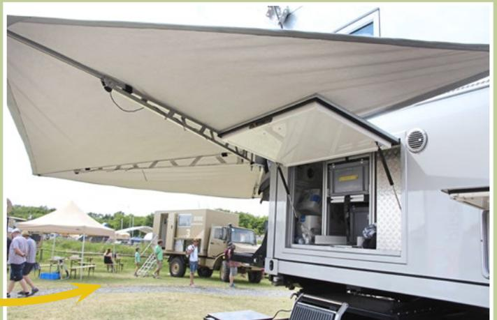
Gleichfalls von Bliss Mobil stammt eine neue Markise. Sie ist zusammengeklappt an der Außenwand befestigt und hält ohne Bodenstangen.
